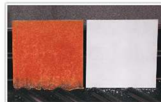
фото: тестирование поверхностей в течение 60 дней (слева - необработанная поверхность, справа - обработанная)
